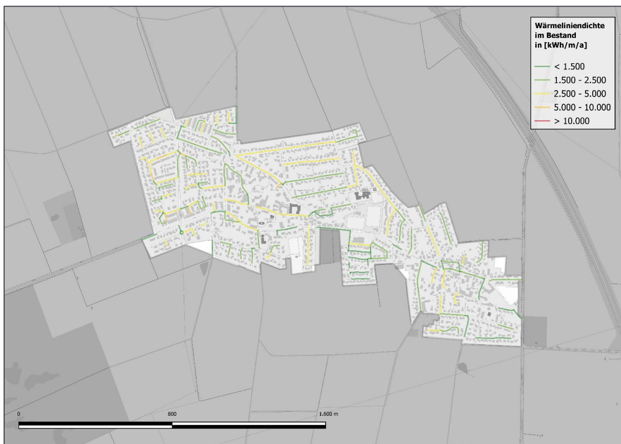
Abbildung 4.4 Wärmeliniendichte im Bestand 2022
