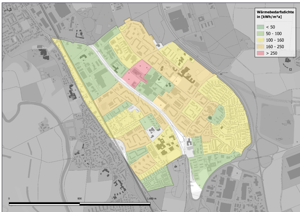
Abbildung 4.3 Wärmebedarfsdichte Bestand 2022 je m 2 beheizte Nutzfläche
